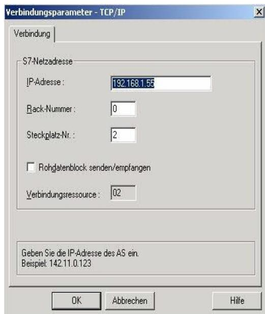
10. Es öffnet sich ein Dialog der Ihnen ermöglicht die Verbindungsparameter zu konfigurieren.
