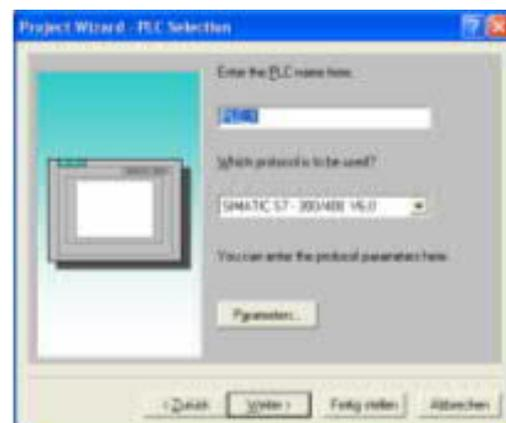
4. Drücken Sie „Weiter“ und Sie gelangen zu einem neuem Dialog indem Sie den Steuerungsnamen sowie die Steuerung angeben können die Sie verwenden. (Beispiel: „SIMATIC S7– 300/400 V6.0“)
