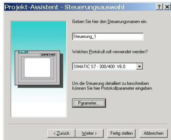
4. Drücken Sie „Weiter“ und Sie gelangen zu einem neuem Dialog indem Sie den Steuerungsnamen sowie die Steuerung angeben können die Sie verwenden. (Beispiel: „SIMATIC S5 – AS511 V6.0“)
