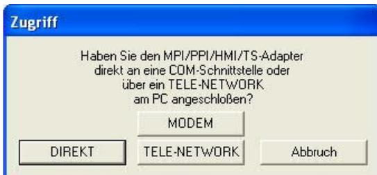
Bei der Zugriffsabfrage wählen Sie „Direkt“ wenn Ihr Produkt mit einem USB-Kabel oder Nullmodem-Kabel angeschlossen ist, „Modem“ wenn Ihr Produkt über eine Telefonstrecke verbunden ist oder „TELE-Network“ wenn Ihr Produkt an einem TELE-Network Gerät angeschlossen ist das Sie über Telefonstrecke erreichen.
