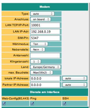
Hier werden die Modemparameter festgelegt. Eine Modemverbindung wird als PPP- Verbindung realisiert. So kann TeleRouter auch mit anderem Einwahlroutern verwendet werden. **Ein idealer Ersatz z.B. für Teleservice IE von Siemens.**
