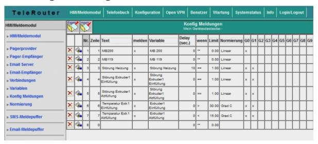
Die eigentlichen Meldungen werden separat konfiguriert. Dort wird der Zusammenhang zwischen Variable, Normierung und Meldegruppe getroffen. Woraus die eigentliche Meldung resultiert. Die Reihenfolge der Meldungen wird nach Eingabe der Zeilennummer vorgenommen.
