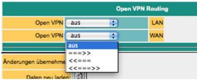
aus: Routing zum Interface nicht möglich ===>: Routing vom VPN zum Interface ←==: Routing vom Interface zum VPN ←=⇒: Routing in beide Richtungen.
