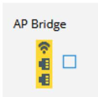
In dieser Betriebsart sind alle Interfaces über eine Bridge miteinander verbunden. Dabei fungiert der Router wie ein handelsüblicher Switch. Die Datenpakete werden eins zu eins von einem Interface zum anderem durchgereicht. Durch diese Konfiguration sind alle Teilnehmer im gleichem IP-Adressraum (z.B. 192.168.2.x/24) und können untereinander kommunizieren.
