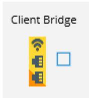
Wie auch in der Betriebsart Client Router verbindet sich der Router mit einem bestehenden WLAN. Anders als bei diesem wird im Bridge Modus jedoch das WLAN auch zum LAN Interface hinzugefügt. So sind alle Teilnehmer der Ethernet Ports sowie des WiFi im gleichen IP-Adressraum und können untereinander kommunizieren.
