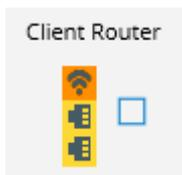
Im Modus Client Router dient das WLAN Interface als WAN-Zugang. Die zwei Ethernet Ports sind mittels Bridge miteinander verbunden und ergeben zusammen den LAN-Bereich. Wie auch in der Konfiguration Access Point Router befinden sich hier die LAN und WAN Interface Ports im gleichem Netz und werden auf das WAN Interface (WLAN) geroutet.
