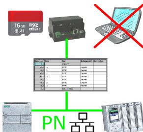
S7-SPS getriggerte DB-Sicherung/-Wiederherstellung ohne zusätzlichen PC über PN-Port auf SD-Karte
