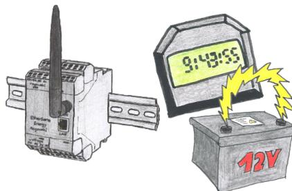
Benötigen Sie immer eine aktuelle Uhrzeit, haben aber nicht immer einen Uhrzeit-Server vor Ort. Mit der integrierten batteriegepufferten RTC haben Sie immer die aktuelle Uhrzeit im Gerät. Selbst bei Spannungsausfall läuft die Uhrzeit im Gerät weiter, so daß bei wiederkehrender Spannung die Uhrzeit korrekt weiterläuft.
