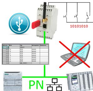
Über digitalen Eingang getriggerte DB-Sicherung/-Wiederherstellung ohne zusätzlichen PC über PN-Port auf USB-Stick
