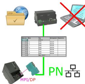
S7-SPS getriggerte DB-Sicherung/-Wiederherstellung ohne zusätzlichen PC über MPI/Profibus auf FTP-Server
