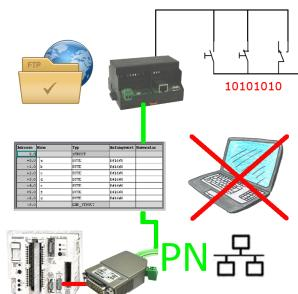
Über digitalen Eingang getriggerte DB-Sicherung/-Wiederherstellung ohne zusätzlichen PC über PG-Buchse und Ethernet auf FTP-Server
