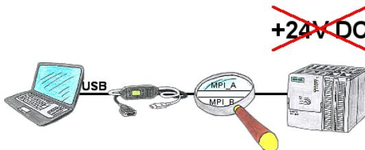
SPS-Zugriff in der Produktionsanlage auf "passive Baugruppen" wie Umrichter oder ET200 oder an einem Bus-Stecker ohne SPS, ohne 24V DC für das Interface-Produkt eigentlich nicht möglich.
