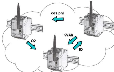
Durch die EtherSens-Cloud kann jedes EtherSens-Gerät mit anderen Geräten Daten austauschen, Daten übertragen und weiterleiten. Als ob Sie ein großes Gerät hätten, das alle notwendigen Parameter zentral erfasst.
