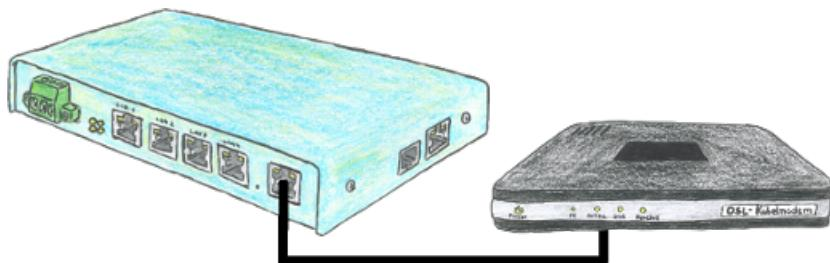
Sie suchen ein Gerät das auch mit DSL betrieben werden kann. Kein Problem, Sie schließen an Ihren TELE-Router PPPoE ein DSL-/Kabelmodem an, geben die Parameter bzgl. der Zugangsdaten ein und Sie sind mit dem Gerät mit Internet verbunden.
