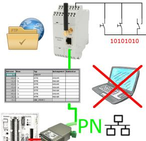
Über digitalen Eingang getriggerte DB-Sicherung/-Wiederherstellung ohne zusätzlichen PC über PG-Buchse und Ethernet auf FTP-Server
