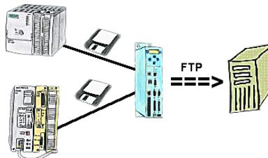
Sie benötigen einen Datenlogger, der spezifizierte Daten von der SPS mitschneidet und Sie je nach Bedarf die Daten per FTP abholen. Kein Problem, mit der Datenlogger-Option sofort mit dem Gerät machbar.
