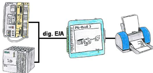
Sie benötigen Produktionsdaten, Lauflisten Ihrer Anlage, möchten aber keinen CP einsetzen oder bekommen keinen seriellen Drucker mehr? Kein Problem, sie benötigen von der Steuerung 8 dig. Ausgänge und 3 dig. Eingänge um den PG-Print anzuschließen und Sie können sofort mit einem EPSON- oder HP-kompatiblen Parallel-Drucker diese Listen generieren.
