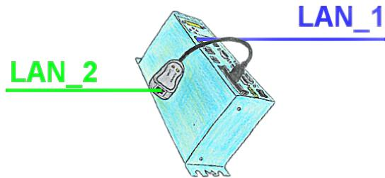
Sie benötigen eine Trennung zwischen Maschinen-Netz und Betriebs-Netz? Kein Problem, Sie stecken in Ihr Tele-Prof-II-Gerät (nur bei Version -H) eine PCMCIA-Netzwerk-Karte und die Trennung ist vollbracht. Sie selbst haben Zugriff auf beide Netzwerke per Fernwartung.
