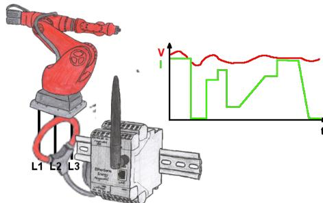
Erfassen Sie die Effizienz Ihrer Anlage/Maschine durch die EtherSens-Energy-Geräte. Loggen Sie vorgegebene Parameter mit und werten diese dann später aus. Stellen Sie dadurch unnötige Leerlaufzeiten fest und erhöhen dadurch die Effizienz.
