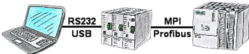
Über das TeleService-Gerät können Sie sich direkt mit Ihrem PC/Laptop seriell oder über USB-Kabel anbinden und somit ohne einen PC-Adapter oder sonstige S7-Programmierkabel direkt mit der Steuerung kommunizieren. Das USB-Kabel ist ein Standardkabel, so wie Sie es an Ihrem Drucker verwenden.
