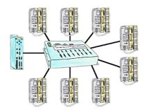
Sie haben mehrere SPS-Steuerungen die Sie zentral an einem Punkt fernwarten müssen? Kein Problem, Sie schließen an diesem zentralen Punkt Ihre Steuerungen am KOR/MUX-Tele-Switch an, verbinden diesen mit dem TP-II und nach Connect können Sie dann über die Pfadanwahl Ihrer Step5-Software ONLINE gehen. Selbstverständlich ist der KOR/MUX-Tele-Switch kaskadierbar, so dass Sie alle möglichen 30 Teilnehmer anschließen können.
