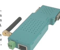
Um den WLAN-Teil zu nutzen verbinden Sie sich mit Ihrem PC mit dem WLAN-Netz „S7-BRIDGE“ und öffnen mit <http://192.168.1.55> (Adresse bei Auslieferung) die Webseite der S7-BRIDGE. Hier können Sie die Parameter WLAN betreffend einstellen und übernehmen. Es steht zur SPS-Schnittstelle natürlich auch die WLAN-Verbindung zur Verfügung.
