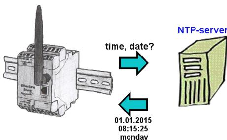
Sollen alle EtherSens-Geräte in Ihren Anlagen zeitsynchron aufzeichnen? Durch die Kopplung mit einem NTP-Zeitserver holen sich alle Geräte die aktuelle Uhrzeit und gleichen diese ab.
