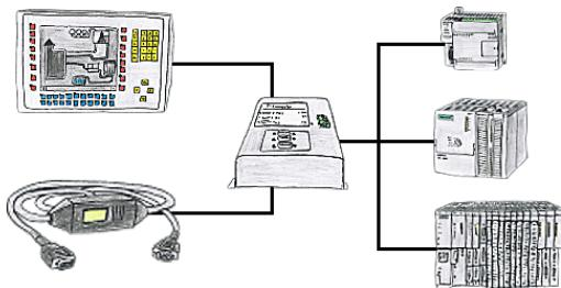
Sie haben eine Einzelsteuerung mit Panel im Einsatz und müssen eine kleine Änderung im Steuerungsprogramm durchführen? Kein Problem, T-Connector an die Steuerung anstecken, Panel und PC an das Gerät und schon können beide Teilnehmer mit der Steuerung ohne lästiges Buskableinziehen und dazwischenschalten arbeiten.
