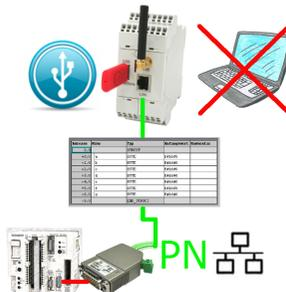
S5-SPS getriggerte DB-Sicherung/-Wiederherstellung ohne zusätzlichen PC über PG-Buchse und Ethernet auf USB-Stick
