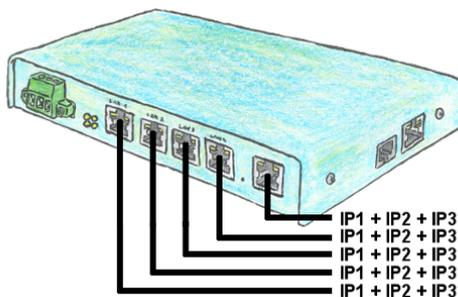
Sie müssen mehrere Netze gleichzeitig fernwarten und Ihr vorhandener Switch/Router hat nicht so viele Anschlüsse? Kein Problem, mit dem TELE-Router sind Sie in der Lage, jedem LAN/WAN-Port bis zu 3 IP-Adressen zu zuordnen, so dass Sie mit den verschiedenen Segmente und Netzen kommunizieren können.
