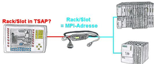
Ihr Panel oder Visualisierungssystem adressiert die gewünschte SPS-Steuerung über RACK/SLOT-Angabe im TSAP? Kein Problem, aktivieren Sie diese Betriebsart im MPI-LAN-Kabel und schon bekommen Sie aktuelle Werte von der Steuerung.
