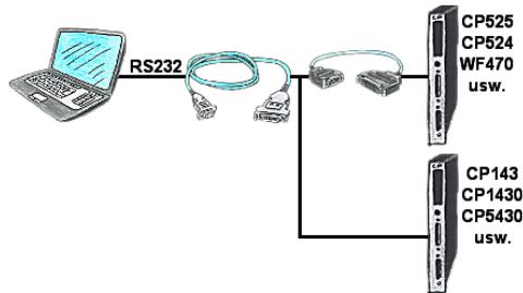
Sie haben einen PC mit Programmiersoftware und als Schnittstelle steht Ihnen der 9polige COM-Port zur Verfügung? Kein Problem, das PG-UNI-II-Kabel ist hier genau das richtige Produkt. An Siemensbaugruppe wie H1-CP (CP1430), WF470 und PC oder CP-525 mit CP525-Adapter und PC angesteckt und Sie sind Online.
