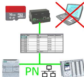
S7-SPS getriggerte DB-Sicherung/-Wiederherstellung ohne zusätzlichen PC über PN-Port auf SD-Karte
