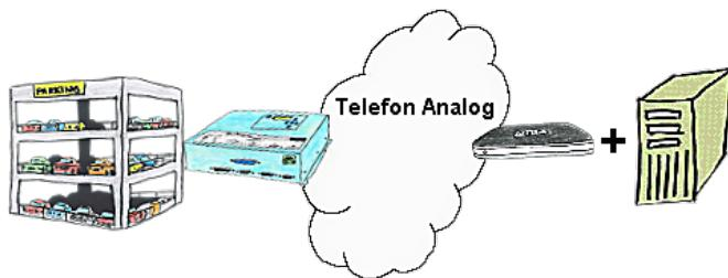
Ihr Parkhaus bzw. die Steuerung sendet Ihnen die Belegung/ Auslastung auf einen PC mit Modem, so dass Sie die Daten zur Weiterverarbeitung verwenden können.
