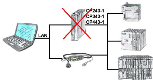
Sie haben eine S7-SPS-Steuerung ohne CP243-1, CP343-1 oder CP443-1 und möchten sich per LAN anbinden? Dann stecken Sie das S7-LAN bzw. MPI-LAN-Kabel auf die SPS-Steuerung und Ihr Zugriff per RFC1006 ist einsatzbereit.
