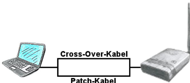
Sie benötigen ALF um in ein vorhandenes WLAN zu verbinden, haben aber nur ein Patch-Kabel zur Hand? Kein Problem, ALF bietet "Autonegotiation" und das heißt für Sie, dass er ein gestecktes Kabel (Patch-Kabel oder Cross-Over-Kabel) erkennt und entsprechend der Belegung sich umstellt, so dass eine Kommunikation möglich ist.
