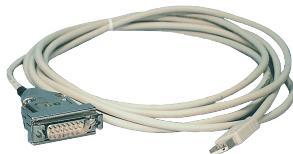
Das PG-USB-Kabel ist ein Programmierkabel für die 15polige PG-Schnittstelle X4/X5 einer S5-CPU. Das Kabel wird am PC an der USB-Schnittstelle (Typ-A) angesteckt. Das Kabel ist gegenüber der Steuerung aktiv, da es sich aus der USB-Schnittstelle versorgt. Für etwaige Sonderbaugruppen kann man sich mit Zusatzadapters, die das Pinning abändern behelfen.
