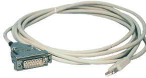
Das PG-USB-Kabel ist ein Programmierkabel für die 15polige PG-Schnittstelle X4/X5 einer S5-CPU. Das Kabel wird am PC an der USB-Schnittstelle (Typ-A) angesteckt. Das Kabel ist gegenüber der Steuerung aktiv, da es sich aus der USB-Schnittstelle versorgt. Für etwaige Sonderbaugruppen kann man sich mit Zusatzadaptern, die das Pinning abändern behelfen.
