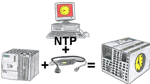
Sie benötigen in Ihrer SPS-Steuerung eine aktuelle Uhrzeit? Kein Problem, mit der NTP-Funktion des MPI-LAN holt sich das Kabel von einem NTP-(Uhrzeit-)Server die aktuelle Uhrzeit und überträgt diese direkt in die parametrierte SPS-Steuerung oder auch in einen DB zur Weiterverarbeitung.
