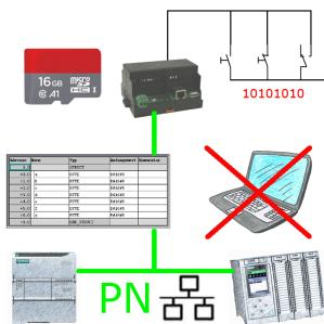
Über digitalen Eingang getriggerte DB-Sicherung/-Wiederherstellung ohne zusätzlichen PC über PN-Port auf SD-Karte
