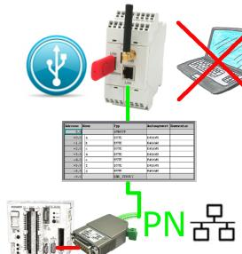
S5-SPS getriggerte DB-Sicherung/-Wiederherstellung ohne zusätzlichen PC über PG-Buchse und Ethernet auf USB-Stick
