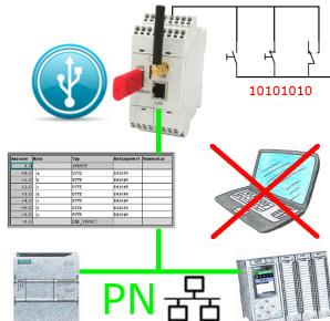
Über digitalen Eingang getriggerte DB-Sicherung/-Wiederherstellung ohne zusätzlichen PC über PN-Port auf USB-Stick
