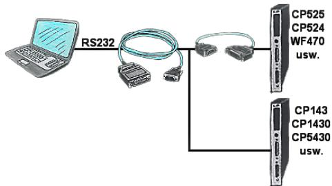
Sie haben einen PC mit Programmiersoftware und als Schnittstelle steht Ihnen der 9polige COM-Port zur Verfügung? Kein Problem, das PG-UNI-Kabel ist hier genau das richtige Produkt. An Siemensbaugruppe wie H1-CP (CP1430), WF470 und PC oder CP-525 mit CP525-Adapter und PC angesteckt und Sie sind Online.
