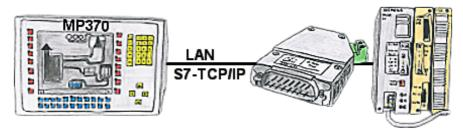
Ihr Panel hat als SPS-Schnittstelle nur eine LAN-Buchse und unterstützt nur noch S7-RFC1006? Kein Problem, verbinden Sie diese Buchse mit dem S5-LAN++ und stecken dieses direkt auf die PG-Schnittstelle der Steuerung. Das S5-LAN++ verhält sich gegenüber Ihrem Panel wie eine S7-SPS-Steuerung obwohl Sie die Daten von einer S5-SPS bekommen. Schon steht Ihnen der Zugriff auf die Variablen und Daten der S5-Steuerung zur Verfügung.
