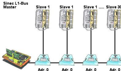
Sie haben einen laufenden Sinec-L1-Bus und Ihr Master der CP530 ist defekt bzw. ausgefallen und der Bus muss weiterlaufen? Kein Problem, anstatt dem CP530 den L1-Controller mit den entsprechenden Bus-Modulen anschließen, Umlaufliste definiert und der L1-Bus läuft sofort weiter.
