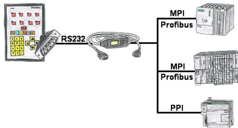
Ihr Panel bietet zum Anschluss einer S7-SPS-Steuerung einen seriellen Port und keinen MPI/Profibus. Schließen Sie das MPI/PPI-Kabel daran an und Sie sind mit Ihrem Panel online.
