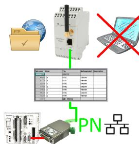
S5-SPS getriggerte DB-Sicherung/Wiederherstellung ohne zusätzlichen PC über PG-Buchse und Ethernet auf FTP-Server
