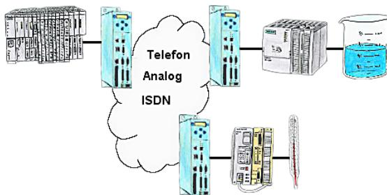
Ihre Pumpstationen melden über das Telefonnetz der Zentralsteuerung die Pegelstände. Die Zentrale selbst kann natürlich auch den Unterstationen Befehle/Meldungen übertragen. Dazu wird keine Standleitung benötigt, es reicht ein normaler" Telefonanschluss, da die Geräte nach erfolgter Meldung die Leitung wieder trennen.
