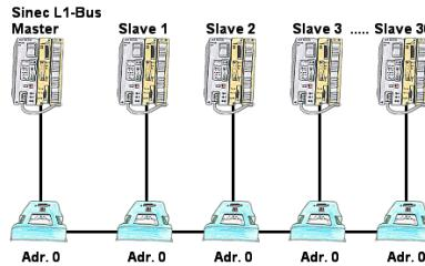
Sie müssen einen Sinec-L1-Bus aufbauen, haben den Master aber bekommen keine BT-777-Klemme zu kaufen? Kein Problem, Sie schließen an jede in Frage kommende S5-SPS-Steuerung die IBX-Klemme über das optionale IBX-SPS-Kabel an, versorgen jede IBX-Klemme mit ext. 24V DC wenn die SPS diese nicht liefern kann, stellen Sie als Adresse 0 ein und definieren die eigentliche L1-Bus-Adresse in der SPS-Steuerung. Schon kann Ihr Master mit den Slavebaugruppen kommunizieren.
