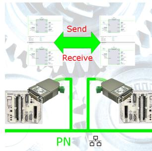
S5-Steuerung mit PG-Port an S5-Steuerung mit PG-Port über Netzwerk koppeln
