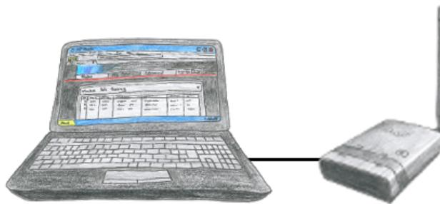
Um ALF zu parametrieren benötigen Sie keine zusätzlichen Treiber oder spezielle Kabel, Sie verbinden sich über LAN oder WLAN mit ALF und über den integrierten WebServer stellen Sie die gewünschte Funktion ein.
