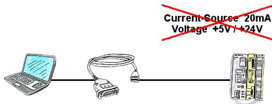
SPS-Baugruppe ohne Stromquellen (+20mA) und Spannungen (5V/24V) an der PG-Schnittstelle wie zum Beispiel die AS511-Steckkarte?
