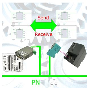
S7-Steuerung mit MPI/Profibus an S5-Steuerung mit PG-Port über Netzwerk koppeln
