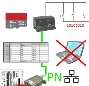
Über digitalen Eingang getriggerte DB-Sicherung/-Wiederherstellung ohne zusätzlichen PC über PG-Buchse und Ethernet auf SD-Karte
