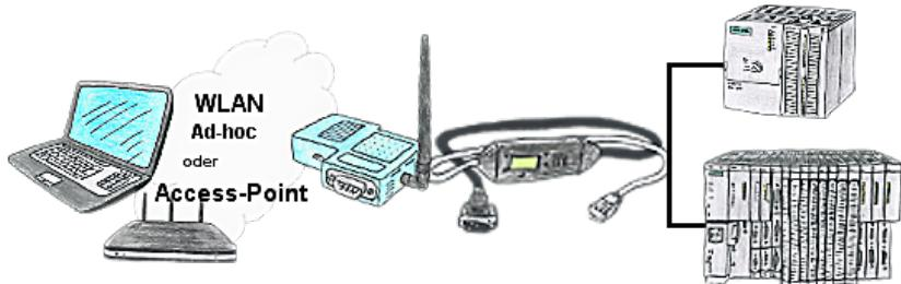
Sie befinden sich vor Ort an Ihrer Anlage und sollten sich um die Maschine bewegen und gleichzeitig steuern/beobachten. Kein Problem, Sie parametrieren die S7-WLAN-Bridge, schließen das MPI-LAN an und verbinden sich mit einem Access-Point vor Ort oder mit dem Ad-hoc-Netzwerk Ihres Laptops und sind ONLINE auf der Steuerung.
