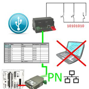
Über digitalen Eingang getriggerte DB-Sicherung/-Wiederherstellung ohne zusätzlichen PC über PG-Buchse und Ethernet auf USB-Stick
