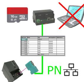
S7-SPS getriggerte DB-Sicherung/-Wiederherstellung ohne zusätzlichen PC über MPI/Profibus auf SD-Karte
