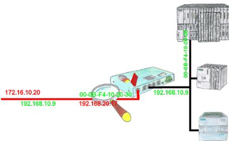
Sie haben in Ihrer Anlage Maschinen verschiedener Hersteller und keiner soll einen Zugriff auf die Steuerungen der anderen bekommen? Kein Problem, mit der S7-Firewall filtern Sie wer überhaupt mit dem Steuerungsnetzwerk kommunizieren darf und welcher Teilnehmer mit welchem Endteilnehmer. Dies geschieht über die IP-Adresse sowie auch MAC-Adresse.
