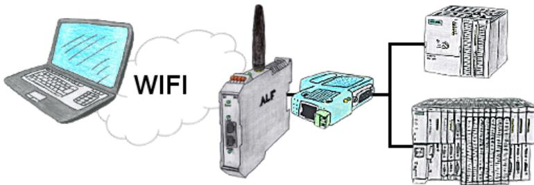
Sie befinden sich vor Ort an Ihrer Anlage und sollten sich um die Maschine bewegen und gleichzeitig steuern/beobachten. Kein Problem, Sie parametrieren den ALF, schließen das S7-LAN an und verbinden sich mit dem WLAN-Netzwerk des ALFs und sind online auf der Steuerung.
