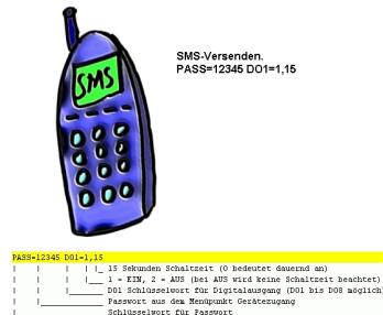
Per SMS einen Ausgang schalten ist eine integrierte Funktion des MESSI. Hiermit wird der Schaltvorgang über die Ferne sicher und nachvollziehbar.
