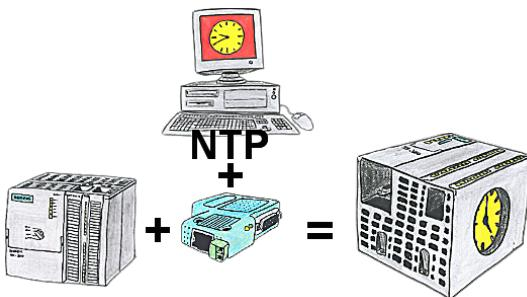
Sie benötigen in Ihrer SPS-Steuerung eine aktuelle Uhrzeit? Kein Problem, mit der NTP-Funktion des S7-LAN holt sich das Modul von einem NTP-(Uhrzeit-)Server die aktuelle Uhrzeit und überträgt diese direkt in die parametrierte SPS-Steuerung oder auch in einen DB zur Weiterverarbeitung.
