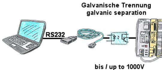
S5-SPS-Kommunikation, hochwertiger PC und Angst um Schnittstellen, unsicher ob SPS geerdet ist oder SPS steht in unsafer Umgebung. Galvanische Trennung ist die praktikabelste Lösung. "PG-ISO-Set" (PG-UNI-Kabel + PG-ISO-Adapter) trennt die Kopplung zur angeschlossenen S5-SPS galvanisch, bietet Schutz des PCs bis zu einem Spannungsunterschied von 1000V.
