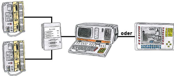
Sie müssen mit mehreren SPS-Steuerungen arbeiten, haben aber keine Lust sich dauernd ab- und anzustecken? Kein Problem, Sie schließen ein Gerät der AG-Switch-Serie an den SPS-Steuerungen sowie Ihren PC/PC an und schon können Sie mit den Steuerungen kommunizieren. Die Auswahl des entsprechenden Teilnehmers führen Sie beim AG-Switch-I mittels Kippschalter und beim AG-Switch-II per 24V-Steuereingang durch.
