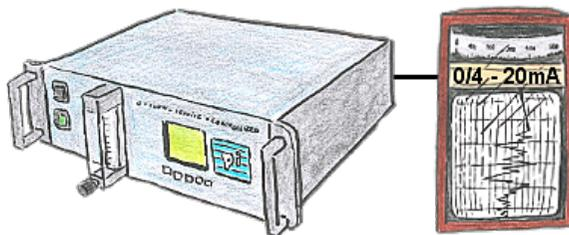
Über den integrierten Stromausgang können Sie den aktuellen Messwert in den Bereichen 0/4 - 20mA über frei wählbare Grenzen ausgeben.
