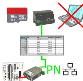
S5-SPS getriggerte DB-Sicherung/-Wiederherstellung ohne zusätzlichen PC über PG-Buchse und Ethernet auf SD-Karte
