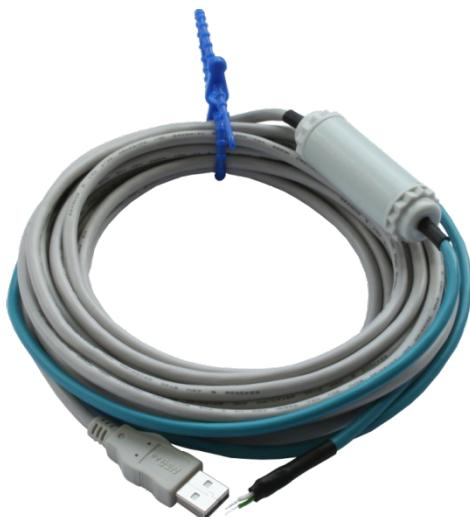
Mit dem USB-Powerkabel generieren Sie aus der USB-Spannung +5V die in der Automatisierungstechnik üblichen 24V DC oder je nach Ausführung auch 12V DC. **Bitte beachten Sie die Aufschrift auf dem Elektronikgehäuse, da wird die Spannung angegeben.**
