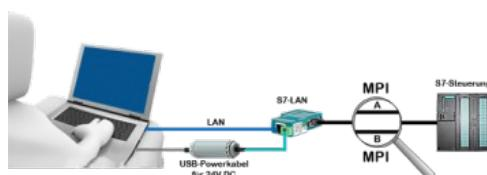
Sie sind vor Ort an Ihrer Anlage, mitten im Feld und haben keine 24V-Versorgung für Ihr S7-LAN-Modul? Stecken Sie das USB-Powerkabel in eine freie USB-Buchse Ihres PCs, koppeln diesen mit dem S7-LAN-Modul und Sie sind sofort Online auf dem angeschlossenen Bus.
