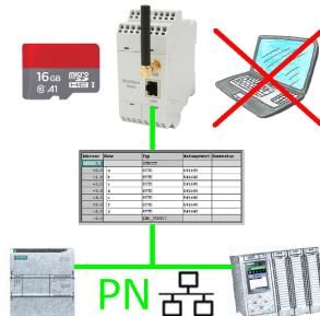
S7-SPS getriggerte DB-Sicherung/-Wiederherstellung ohne zusätzlichen PC über PN-Port auf SD-Karte
