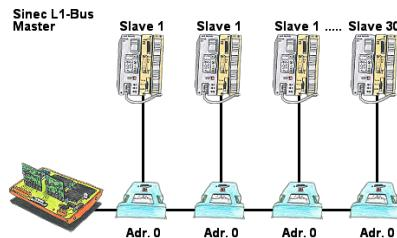
Sie haben einen laufenden Sinec-L1-Bus und Ihr Master der CP530 ist defekt bzw. ausgefallen und der Bus muss weiterlaufen? Kein Problem, anstatt dem CP530 den L1-Controller mit den entsprechenden Bus-Modulen anschließen, Umlaufliste definieren und der L1-Bus läuft sofort weiter.
