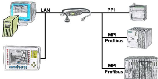
Ihr Panel hat als SPS-Schnittstelle nur eine LAN-Buchse? Kein Problem, verbinden Sie diese Buchse mit dem S7-LAN oder dem MPI-LAN-Kabel und stecken dieses direkt auf den PPI/MPI/Profibus der Steuerung. Schon steht Ihnen der Zugriff auf die Variablen und Daten der Steuerung zur Verfügung.
