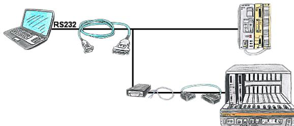
Sie haben einen PC mit Programmiersoftware und als Schnittstelle steht Ihnen der 9polige COM-Port zur Verfügung? Kein Problem, das PG-UNI-II-Kabel ist hier genau das richtige Produkt. An SPS und PC ansteckten und Sie sind online. Die Kommunikation selbst können Sie über die beiden integrierten LEDs beobachten. Sogar die 25polige Schnittstelle der AS511-Karte ist hier kein Problem, Sie benötigen den Netz-Adapter sowie den AG-150-Adapter und auch diese Steuerung ist programmierbar.
