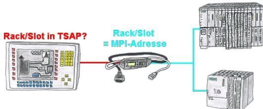
Ihr Panel oder Visualisierungssystem adressiert die gewünschte SPS-Steuerung über RACK/SLOT-Angabe im TSAP? Kein Problem, aktivieren Sie diese Betriebsart im MPI-LAN-Kabel und schon bekommen Sie aktuelle Werte von der Steuerung.
