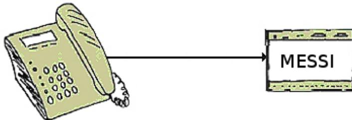
Die MESSI-Gegenstelle wird über das integrierte Mobiltelefon direkt angewählt. Ist eine Verbindung zustande gekommen, werden digitale EIN- und AUSGÄNGE zum Fernschalten übertragen. Jedes Gerät kann sowohl Zustände übertragen bzw. Schaltsignale empfangen.
