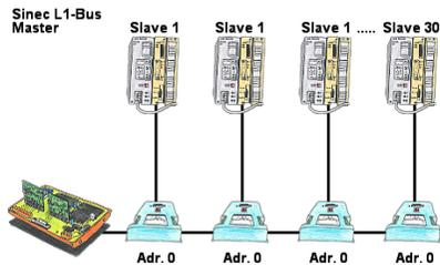
Sie haben einen laufenden Sinec-L1-Bus und Ihr Master der CP530 ist defekt bzw. ausgefallen und der Bus muss weiterlaufen? Kein Problem, anstatt dem CP530 den L1-Controller mit den entsprechenden Bus-Modulen anschließen, Umlaufliste definiert und der L1-Bus läuft sofort weiter.
