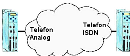
Sie haben vor Ort als Infrastruktur ISDN, aber im Büro einen analogen Anschluss. Kein Problem, Sie installieren bei Ihrem Kunden ein TP-II-Gerät und aktivieren im Gerät die Emulation. Jetzt werden die Modemsignale digitalisiert über ISDN übertragen und Sie haben Ihre benötigte Verbindung. So können Sie trotz unterschiedlicher Systeme kommunizieren und müssen nicht Ihren Kunden behelligen Ihnen einen analogen Anschluss zur Verfügung zu stellen.
