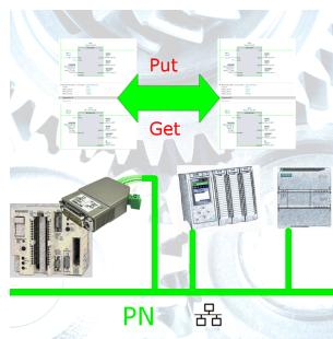
S7-PN-Steuerung an S5-Steuerung mit PG-Port über Netzwerk koppeln
