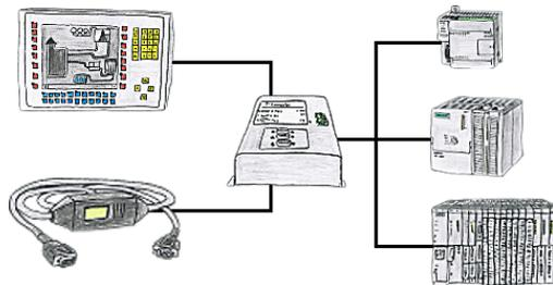
Sie haben eine Einzelsteuerung mit Panel im Einsatz und müssen eine kleine Änderung im Steuerungsprogramm durchführen? Kein Problem, T-Connector an die Steuerung anstecken, Panel und PC an das Gerät und schon können beide Teilnehmer mit der Steuerung ohne lästiges Buskabeleinziehen und dazwischenschalten arbeiten.
