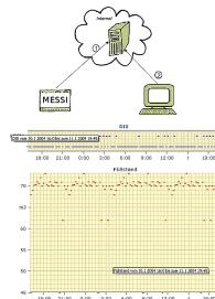
Zyklisches Datenloggen oder bei bestimmten Ereignissen ist realisierbar. Die Loggdaten werden dann z.B. einmal pro Tag per E-Mail übertragen. Spezielle Datenloggerfunktionen können auf Anfrage realisiert werden und sind nicht Bestandteil der Basisfunktion.
