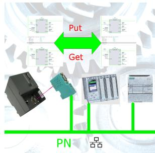
S7-PN-Steuerung an S7-Steuerung mit MPI/Profibus über Netzwerk koppeln
