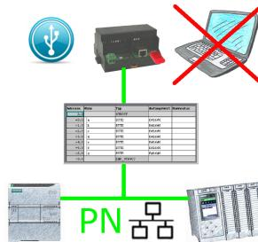
S7-SPS getriggerte DB-Sicherung/-Wiederherstellung ohne zusätzlichen PC über PN-Port auf USB-Stick
