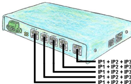
Sie müssen mehrere Netze gleichzeitig fernwarten und Ihr vorhandener Switch/Router hat nicht so viele Anschlüsse? Kein Problem, mit dem TELE-Router sind Sie in der Lage, jedem LAN/WAN-Port bis zu 3 IP-Adressen zu zuordnen, so dass Sie mit den verschiedenen Segmenten und Netzen kommunizieren können.
