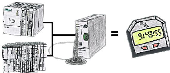
Sie benötigen für Ihre S7-SPS-Steuerung eine genaue Uhrzeit? Kein Problem, das TeleService-GSM holt sich über GPRS von einem Uhrzeitserver die aktuelle Uhrzeit und teilt diese der S7-SPS-Steuerung mit. Wie oft und wann die Uhrzeit aktualisiert werden soll, kann im Gerät parametriert werden.
