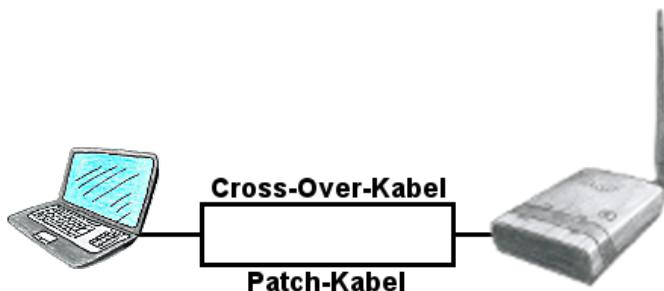
Sie benötigen ALF um in ein vorhandenes WLAN zu verbinden, haben aber nur ein Patch-Kabel zur Hand? Kein Problem, ALF bietet "Autonegotiation" und das heißt für Sie, dass er ein gestecktes Kabel (Patch-Kabel oder Cross-Over-Kabel) erkennt und entsprechend der Belegung sich umstellt, so dass eine Kommunikation möglich ist.
