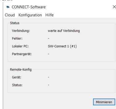
Im Menu „Cloud“ kann man nach seinen Geräten suchen und sich diese Anzeigen lassen. Gegebenenfalls die Verbindung trennen, die Adresse des Partnergerätes anzeigen lassen sowie die Konfiguration des Partnergerätes mit „Remotekonfiguration“ betrachten und ändern.
