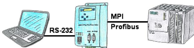
Über das MPI/PPI/Profibus-Modem können Sie sich direkt mit Ihrem PC/Laptop seriell anbinden und somit ohne einen PC-Adapter oder sonstige S7-Programmierkabel direkt mit der Steuerung kommunizieren.
